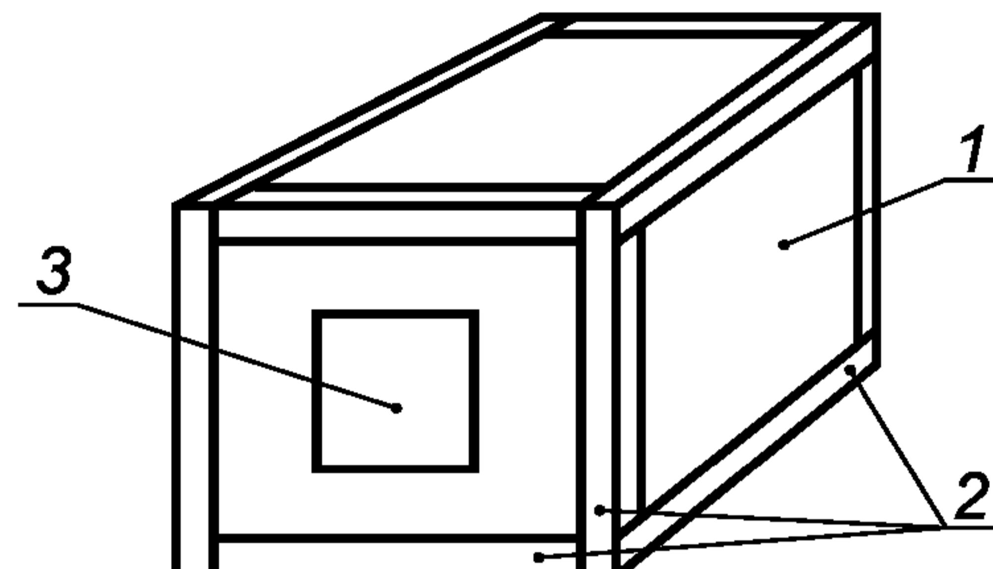
1 — защитная оболочка; 2 — рама из уголка  $40 \times 40$  мм; 3 — крышка испытуемого образца
