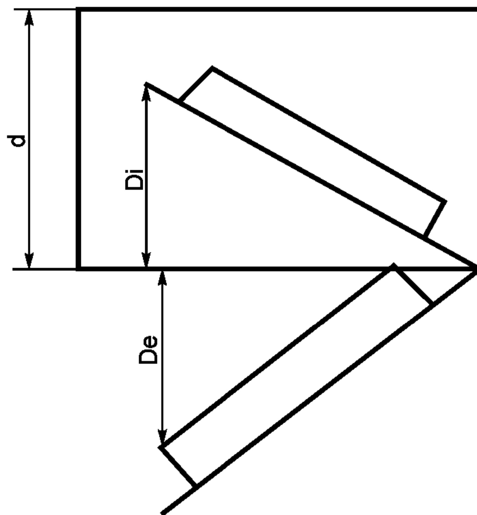
Полный доступ достигается, если  $D_i \geq 100$  мм или  $\geq d/2$ , если  $d < 100$  мм, или  $D_e \geq 100$  мм
