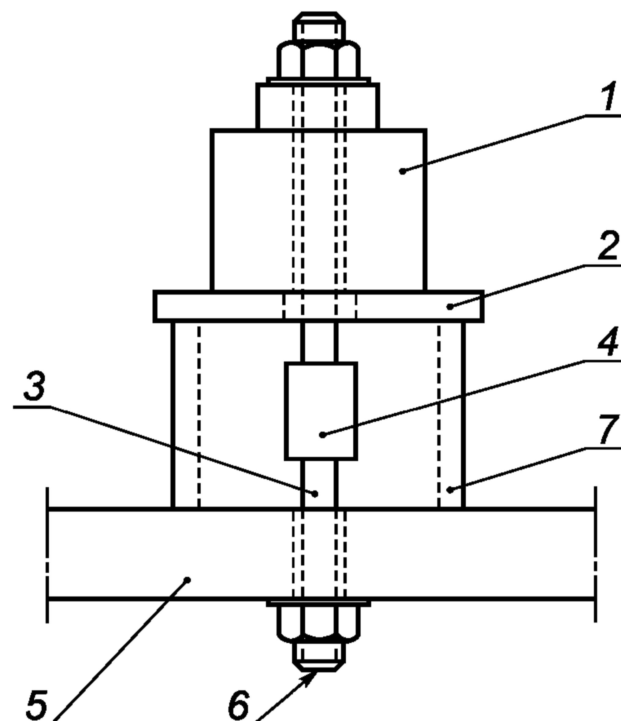
1 — *домкрат*; 2 — стальная опорная плита; 3 — узел крепления; 4 — переходник и средство измерения нагрузки; 5 — стенка шкафа толщиной  $d$  мм с отверстием под крепление; 6 — компоненты крепления в соответствии с описанием в инструкции; 7 — поддерживающий цилиндр внутренним диаметром  $(100 \pm 2)$  мм
