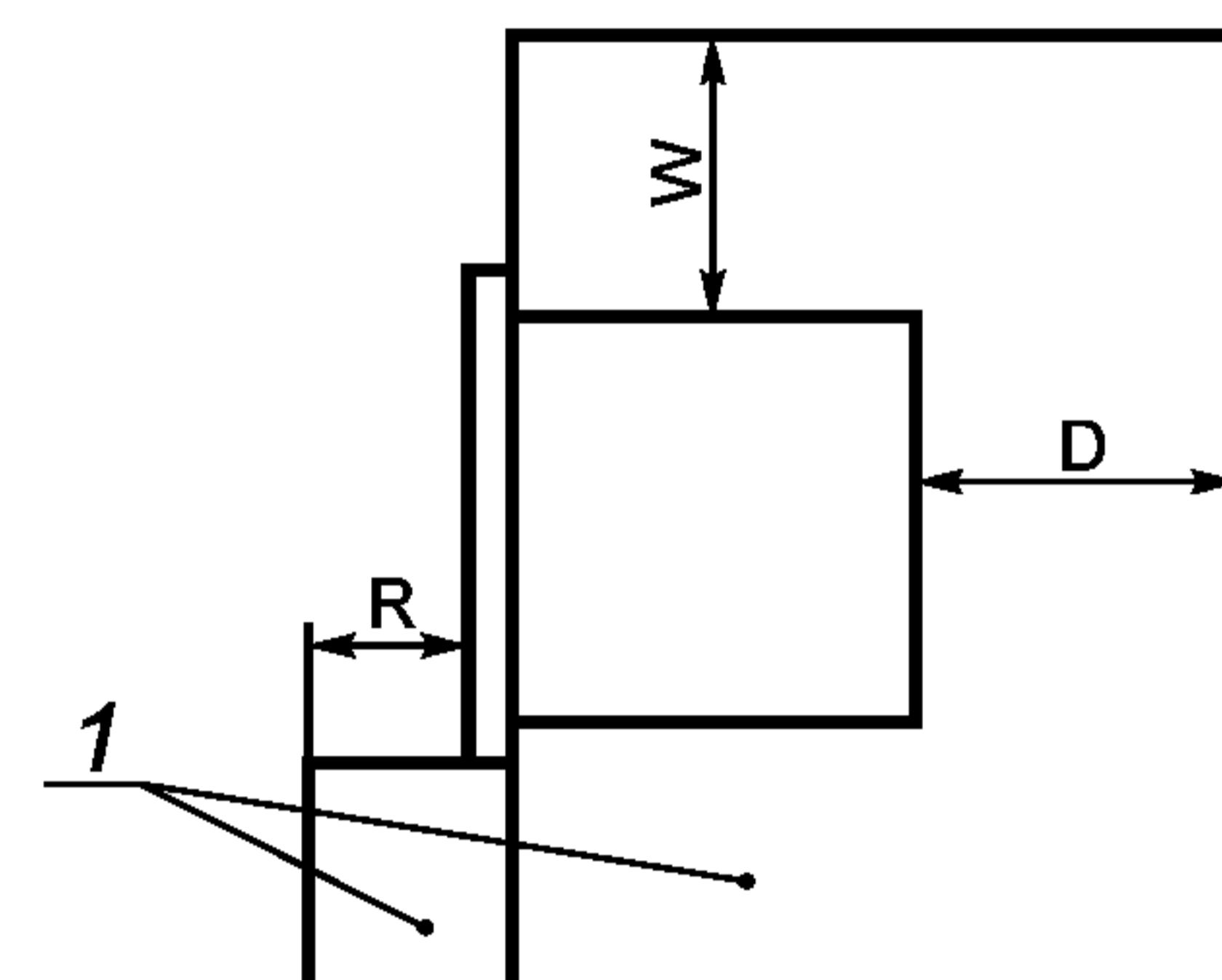
1 — защитная оболочка; W — толщина защитной оболочки сверху, снизу и с боковых сторон испытуемого образца, удвоенная по сравнению со значениями, указанными в инструкциях поставщика (см. 6.1.1.5.d); D — толщина защитной оболочки с тыльной стороны образца (значение из инструкции поставщика (см. 6.1.15.d)); R — глубина выемки от лицевой поверхности стены до двери *шкафа* (значение из инструкции поставщика (см. 6.1.1.5.d))
